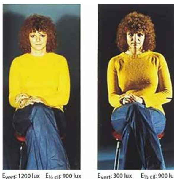
Figuur 3: Licht van de voorkant resulteert in een hoge verticale en een hoge half-cilindrische verlichtingssterkte (links). Licht van de zijkanten resulteert in een even hoge half-cilindrische verlichtingssterkte en betere zichtbaarheid bij een veel lagere verticale verlichtingssterkte.
