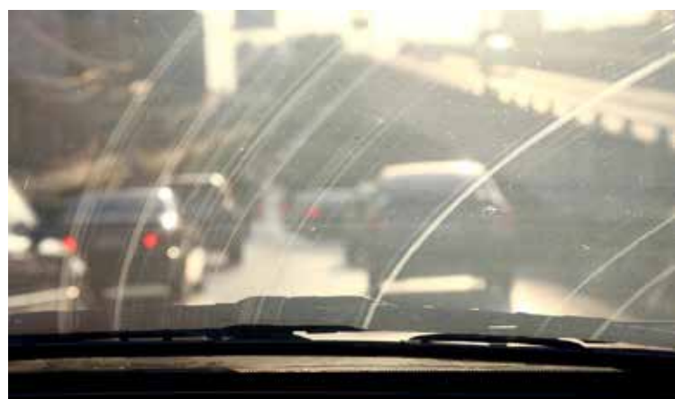
Figuur 4: Lichtsluier in een vuile autoruit.
