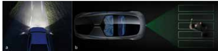
Figuur 2a: Middenstrepen op rijbaan geprojecteerd met licht vanuit de auto (foto: BMW). Figuur 2b: veilig-oversteken signaal geprojecteerd met licht vanuit zelfrijdende auto (foto: Mercedes-Benz).
